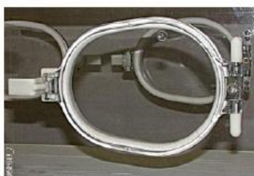
Fig.2 Portillos Iris y Puerta de acceso de la incubadora neonatal. Fuente ECRI. Tomada en enero de 2013. Disponible en www.ecri.org
